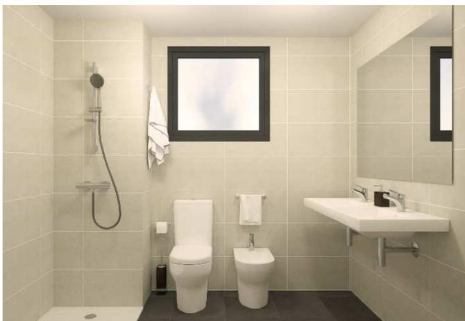
En baño secundario el revestimiento de paredes se realizará con paquetas de gres con formato 20x60 en color blanco roto, de la marca **Saloni** o similar y el pavimento se realizará con plaqueta de gres gris oscuro de la marca **Saloni** o similar.
